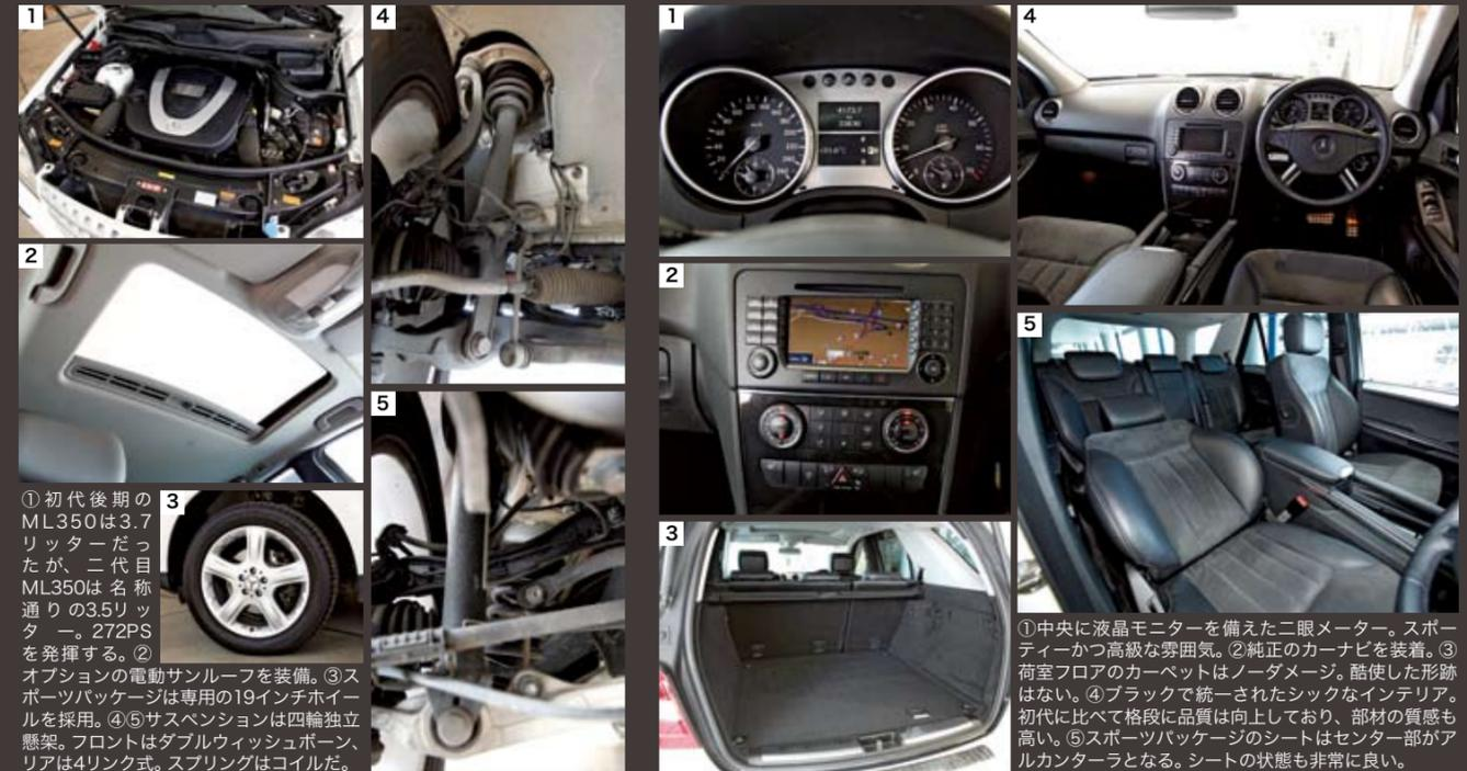
①初代後期のML350は3.7リッターだったが、二代目ML350は名称通りの3.5リッター。272PSを発揮する。②オプションの電動サンルーフを装備。③スポーツパッケージは専用の19インチホイールを採用。④⑤サスペンションは四輪独立懸架。フロントはダブルウィッシュボーン、リアは4リンク式。スプリングはコイルだ。
