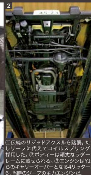
①伝統のリジッドアクスルを踏襲。ただしリーフに代えてコイルスプリングを採用した。②ボディは頑丈なラダーフレームに載せられる。③エンジンはYJからのキャリーオーバーとなる4リッター直6。当時のジープの主力エンジンだ。
