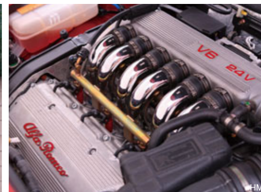
メッキ処理されたインテークパイプが旧世代V6ユニットのトレードマーク。その源流は1979年デビューの大型サルーン、アルファ6(sei)に辿ることができる。取材協力=アルファ・ロメオ田園調布アプルーブドカーセンター Tel. 03-3721-1565
