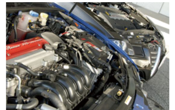
新旧の直4JTSユニット。手前のブレラ用2.2ℓはGM製ユニットがベース。“ツインフェザー”と呼ばれる吸排気連続可変バルブタイミング機構を備える。奥のGT用2ℓは旧来のツインスパークをベースに直噴化したもの。
