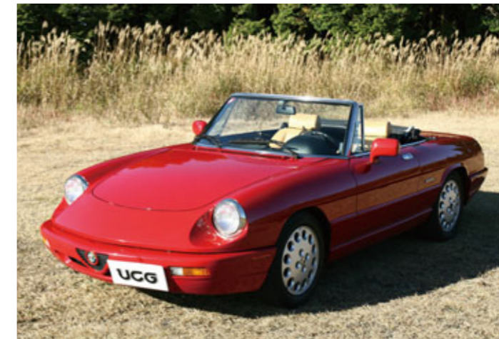
試乗車はシリーズ4の5段MT仕様。搭載される2ℓ直4DOHCエンジン(126ps/5800rpm、17.0mkg/4200rpm)は1090kgのボディを軽快に引っ張る。全長4270×全幅1630×全高1290mm。ボディ・デザインを担当したのはピニンファリーナ。車両協力=コレツィオーネ世田谷店(92年式アルファ・ロメオ スパイダー・ヴェローチェ 走行5.6万km 価格158万円) Tel.03-5758-7007
