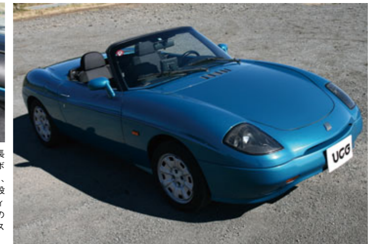
96年に上陸した先代のフィアット・バルケッタ。全長3920×全幅1640×全高1265mmのコンパクトなボディに1.8ℓ直4DOHCユニット(130ps/6300rpm、16.7mkg/4300rpm)を搭載。車重は1090kg。5段MTを介して前輪を駆動する。ボディ・デザインはフィアット社・デザインセンター。99年には限定モデルのリミテッドエディションも登場している。撮影車両はスーザン史子さんのマイカー(96年式)。
