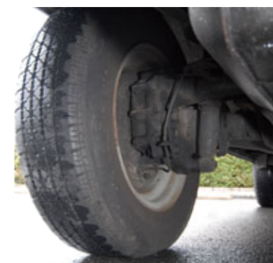
リダクションギアを車両後方から覗く。戦時中に作られたジープタイプの軍用車“キューベルワゲン”から頂戴したアイデアで、結果としてビートルより車高が上がっている。
