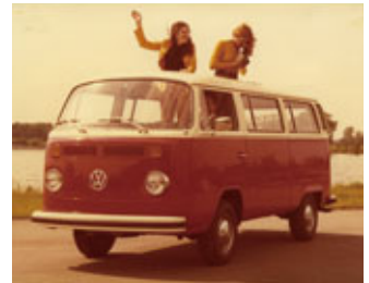
グリルの横にウインカーランプが移動。79年の生産終了までこの顔となった。
