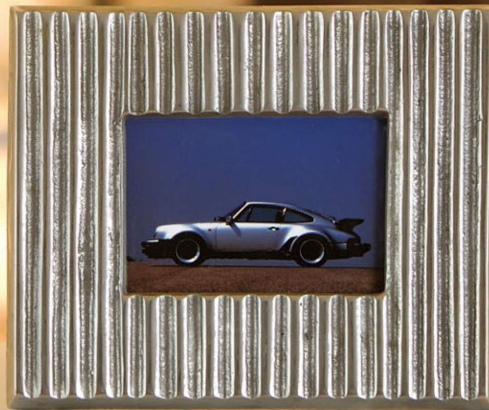
911ターボ(1989)_4291×1775×1310mm W/B 2272mm 1335kg 空冷水平対向6気筒 SOHCターボ 97.0×74.4mm 3299cc 7.0:1 300ps/5500rpm 43.8mkg/4000rpm 5段MT
