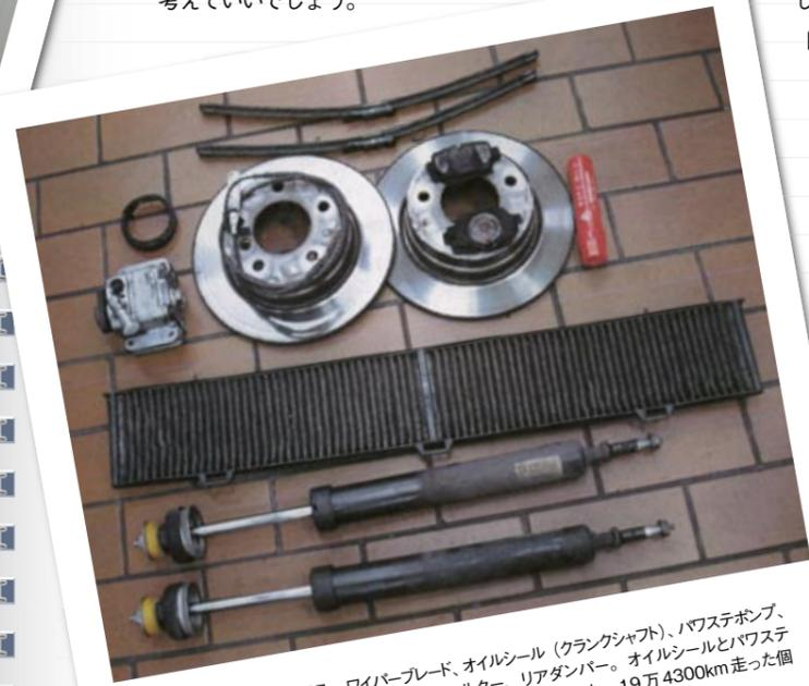
車検の際に交換した部品。ワイパーブレード、オイルシール(クランクシャフト)、パワステポンプ、リアブレーキパッド、発煙筒、エアコンフィルター、リアダンパー。オイルシールとパワステポンプは保証でカバーされたので、総額16万5690円だった。19万4300km走った個体にしては安いこれがBMW車の真実なのだ。
