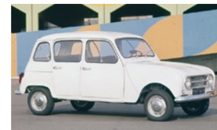
1961年の登場以来32年にわたり生産が続けられたキャトル(4)。デビューの頃“SUPER”に搭載されていた水冷747cc直40HVエンジンは32psを発揮した。
