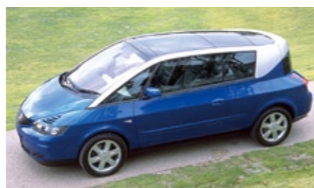
2002年に上陸を果たしたアヴァンタイム。モノスペース・カーながらクーペのカテゴリーに入る。207psを発揮する3リッターV6ユニットを搭載。5段ATを介して前輪を駆動。
