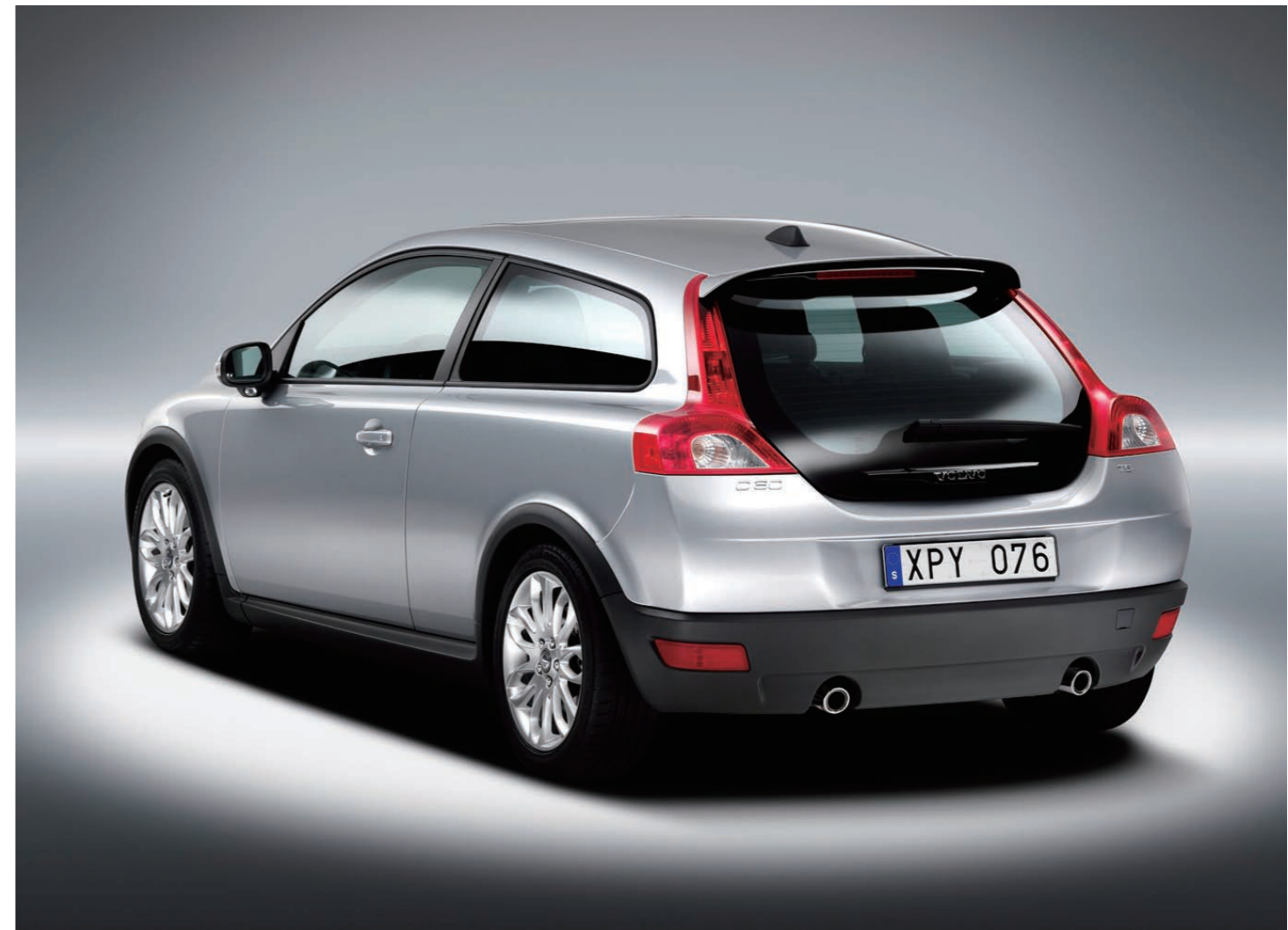
コンポーネツの多くをS40/V50から受け継いでいるC30。ホイールベースも共通だが、全長4250×全幅1780×全高1430mmのスリーサイズは現行ラインナップで最も小さいボルボとなる。個性的なデザインを採用するリアセクションは大きなガラスだけが開くタイプ。軽い力で開閉できるし、斜め上方向に大きく開くので荷物の積み下ろしはラクにできる。
