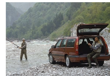
850シリーズ 頭につく8の数字が示すとおり、ラインナップのなかでは700シリーズと900シリーズの中間に位置づけられるモデルだ。2桁目の5は5気筒を意味している。新開発のエンジン、前輪駆動、リアのデルタリンク・サスペンション、そして丸みを帯びてグッと洗練されたエクステリア・デザインなどが、新世代ボルボの象徴的な存在となった。バブルが弾けた直後に上陸したにもかかわらず、特に1993年に登場したワゴンのエステートは記録的なヒットとなった。
