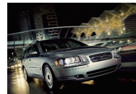
NEW V70シリーズ 2000年にリリースされた二代目V70は、850の進化版・初代V70と区別するためNEW V70と呼ばれた。直列5気筒ユニットを横置きにして前輪を駆動するという基本的な成り立ちは変わらないものの、コンポーネントのほとんどを刷新している。2.5リッター直5ロープレッシャーターボ(200ps / 29.1mkg)、2.4リッター直5ハイプレッシャーターボ(250ps / 33.7mkg)、自然吸気の2.5リッター直5(170ps / 22.9mkg)など、多彩なパワーユニットが用意された。
