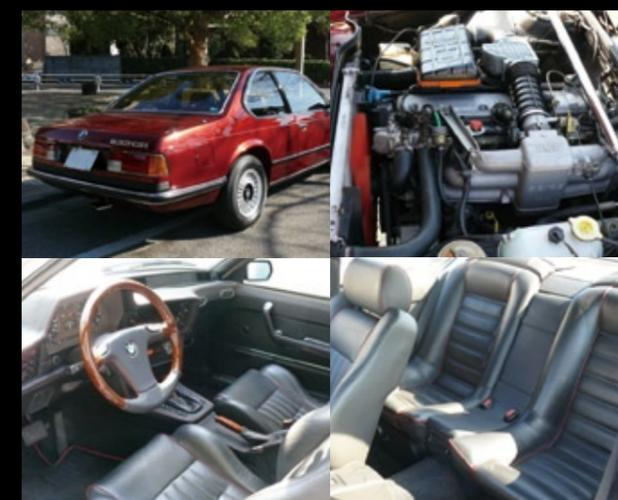
エンジンは、水冷直列6気筒SOHC。630CS用は2985ccで、4バルブキャブ1基と組み合わされて185ps/5800rpmを発生。633CSi用は3205ccで、ポッシュドジェットロニックを組み合わされて200ps/5500rpmを発生した。78年に登場した635CSiには、218ps/5200rpmを発生する3453ccエンジンが搭載された。撮影車両のインテリアは、「Silky6」のオリジナル。リアシートの居心地もよく、大人が長時間座っていても快適だった。流麗なエクステリア・デザインからは想像もつかない“高い実用性”もE24型6シリーズの魅力のひとつだ。
