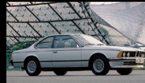
美しいだけでなく空力的にも洗練されていたボディは、先代のCSクーペ同様、カルマン社がコーチワークを担当した。フロントサスペンションは、マクファーソンストラット/コイル。リアは、セミトレーリングアーム/コイルだ。ブレーキは、4輪ともサーボ付きのベンチレーテッドディスクである。
