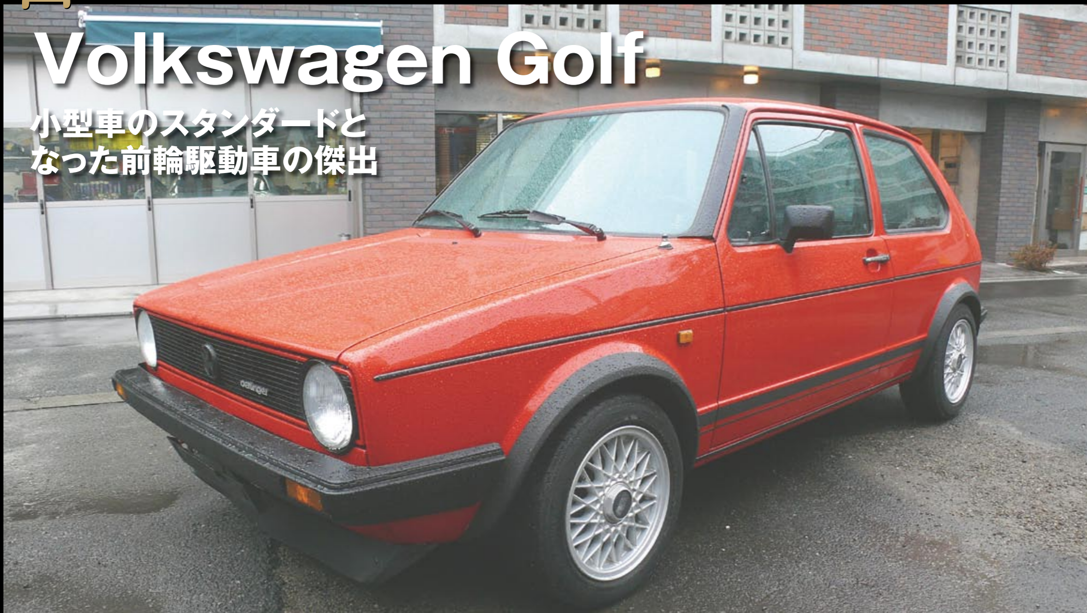
現車はOettingerがチューンした特別なゴルフ。エンジンヘッド、スロットル、インテークマニホールドがOettingerオリジナルパーツに換装されている。「羊の革を被った狼」と評されたポテンシャルの高さ（動きの軽快さ、ボディの剛性感、エンジンの吹上がり等の良さ等）を今でも実感できる。ノーマル仕様と比較してみると、より一層Oettingerの凄さ＆迫力を堪能できるに違いない。一度ショップを訪問してみるといいだろう。撮影協力：ハイトタイムコーポレーション http://www.hightime.co.jp/
