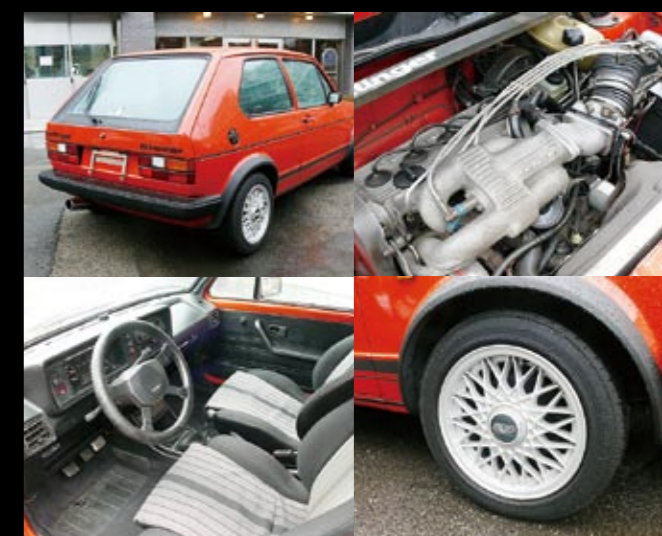
現車はOettingerがチューンした特別なゴルフ。エンジンヘッド、スロットル、インテークマニホールドがOettingerオリジナルパーツに換装されている。「羊の革を被った狼」と評されたポテンシャルの高さ（動きの軽快さ、ボディの剛性感、エンジンの吹上がり等の良さ等）を今でも実感できる。ノーマル仕様と比較してみると、より一層Oettingerの凄さ＆迫力を堪能できるに違いない。一度ショップを訪問してみるといいだろう。撮影協力：ハイトタイムコーポレーション http://www.hightime.co.jp/
