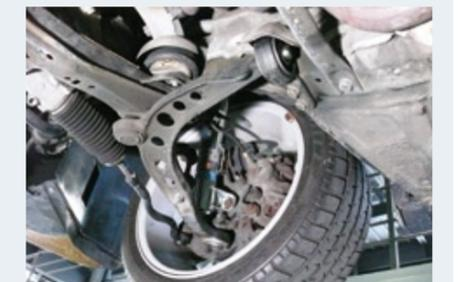
E36型クーペの足まわりにE36型M3用パーツを組み込むことによって、ワインディングロードはもちろん、サーキットも安全に走れる痛快なクルマが完成する。写真は実際にE36型M3用ブッシュ等を足まわりに組み込んだE36型クーペで、抜群の回頭性を有しているとのことだった。
