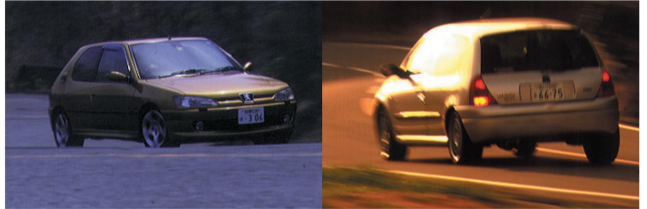
ともに2L直4 DOHC16バルブのハイチューンユニットを搭載。最高出力/最大トルクはS16(左)が163ps/6500rpm、19.3mkg/5500rpm、クリオRS(右)が172ps/6250rpm、20.4mkg/5400rpm。さすがにホットモデルを名乗るだけあって、両車ともトップエンドまできれいに吹け上がる。S16は全長4030×全幅1695×全高1390mm、対するクリオRSはひと回りコンパクトで3770×1670×1410mm。車重はクリオRSが140kgも軽い1060kg。(車両協力=306:ブルーライオン大和/Tel.046-275-8000)
