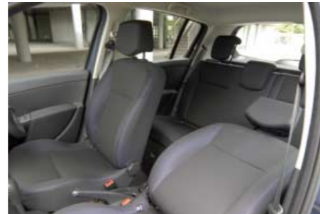
キャビンの雰囲気は良くも悪くも無国籍風。使い勝手が良いが個性は薄い。後席は6:4分割の可倒式。
