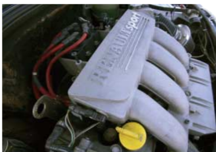
2ℓながら172ps/6250rpm、20.4mkg/5400rpmを発揮するエンジンは、まさにF1直系。誇らしげにRENAULTsportの文字が刻まれている。
