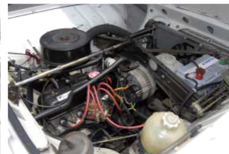
縦置き1.1ℓ直4ユニットは34ps/7.5mkgのパワーとトルクを絞り出す。4段MTを介して前輪を駆動。
