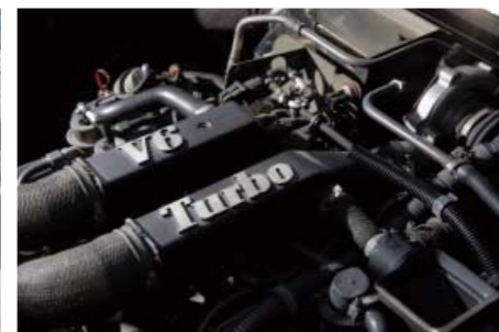
プジョーやボルボと共同開発した2.5ℓ SOHC V6にターボを装着。軽量のFRP製ボディのおかげで最高速は250km/h。
