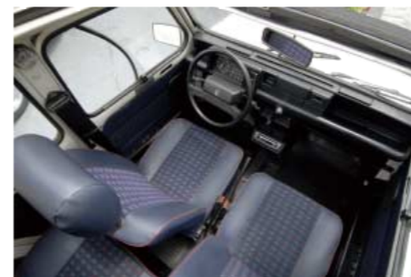
ダッシュの真ん中から付き出しているのがシフトレバー。押す・引く・倒すことで変速操作を行なう。
